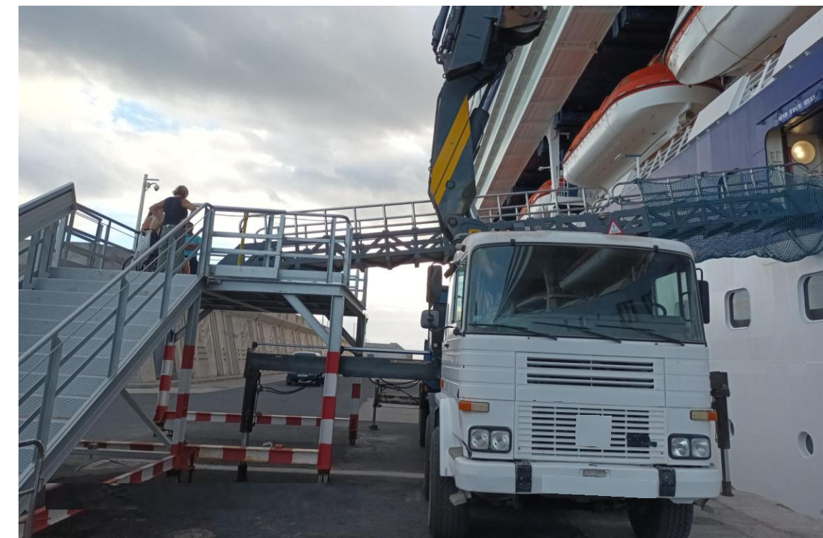
Alinear adecuadamente el buque con el castillete y pasarela según las marcas en el muelle.
