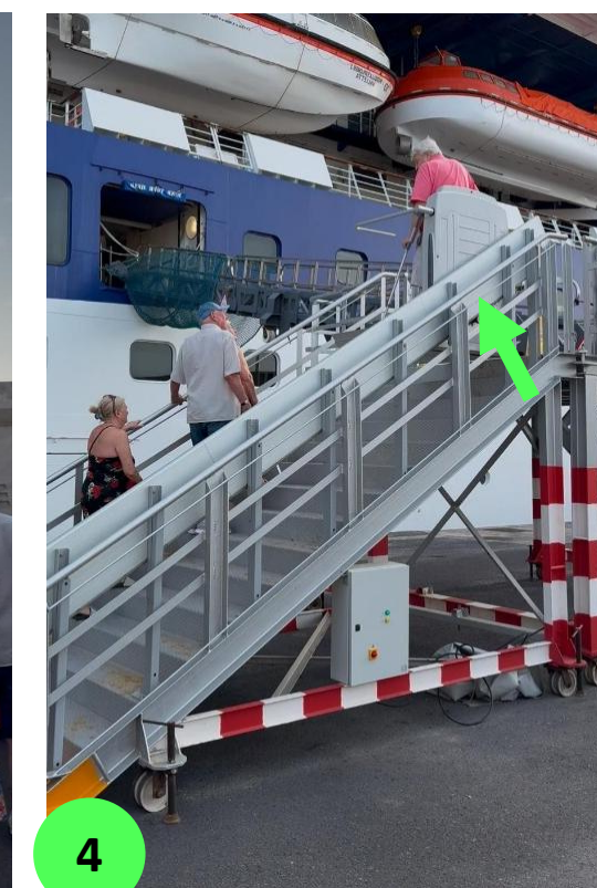
Paso 4: Apertura de la barandilla de seguridad para la bajada del pasajero de la salvaescalera.
