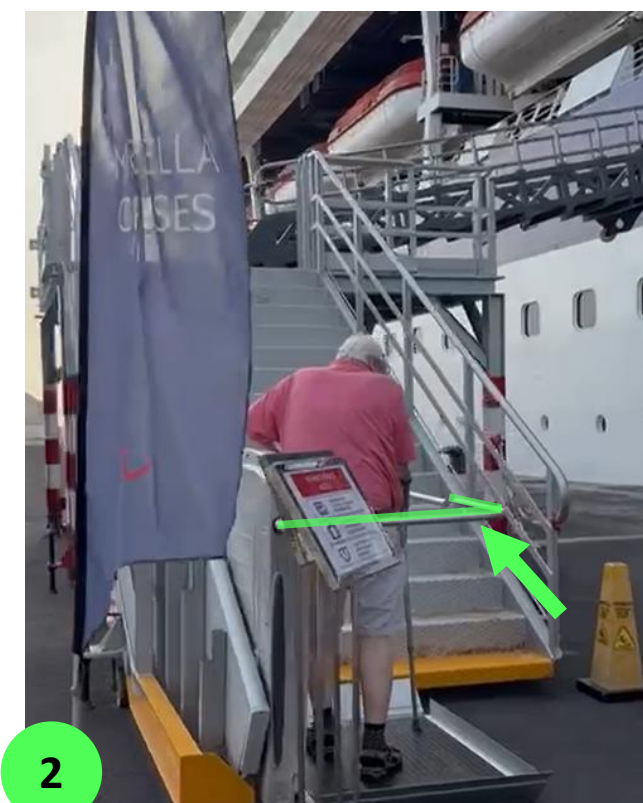
Paso 2: Bajada de la segunda barandilla de seguridad.
